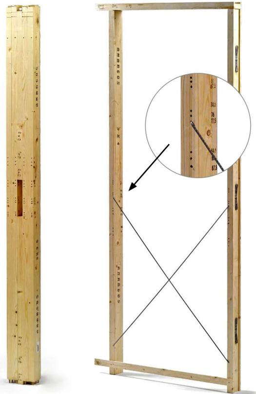
El departamento de I+D de Amargós, ha desarrollado un sistema de fácil montaje que permite montar un precerco sin necesidad de maquinaria ni herramientas específicas, simplemente se precisa un martillo, dos clavos y una sierra. Se incluye en el precerco, dos varillas y la traba de madera.
