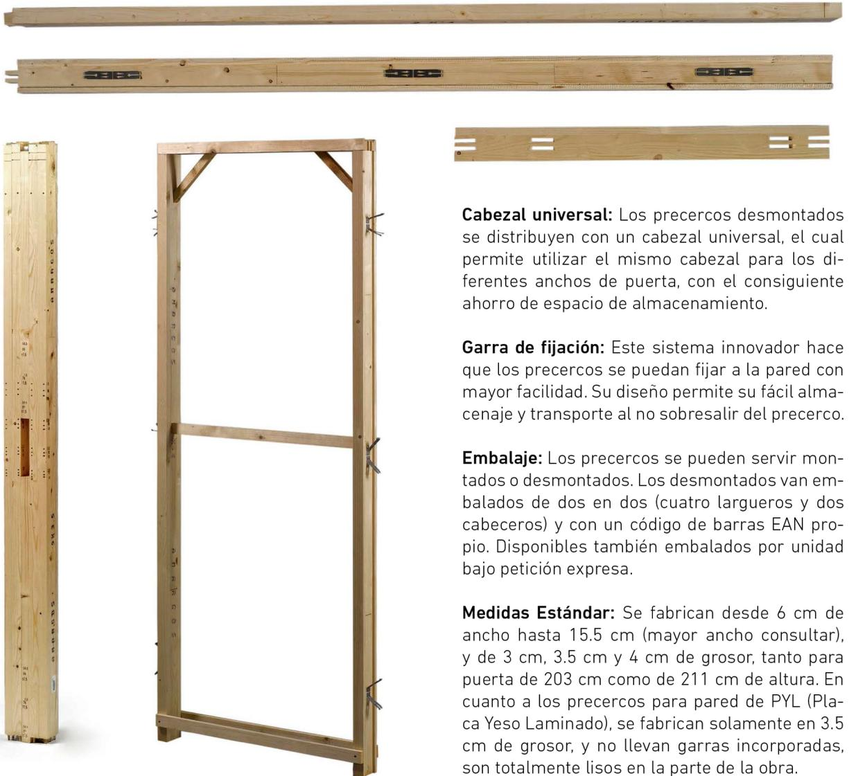
**Cabezal universal:** Los precercos desmontados se distribuyen con un cabezal universal, el cual permite utilizar el mismo cabezal para los diferentes anchos de puerta, con el consiguiente ahorro de espacio de almacenamiento.
